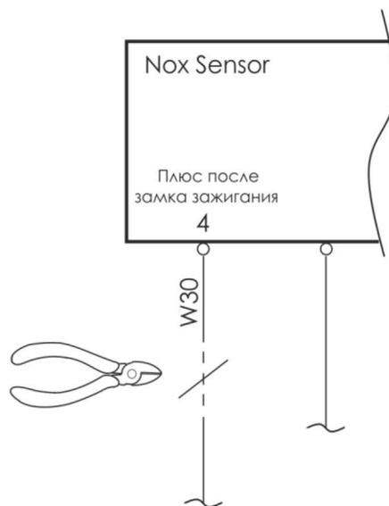
**Пример подключения эмулятора на автомобиль**
