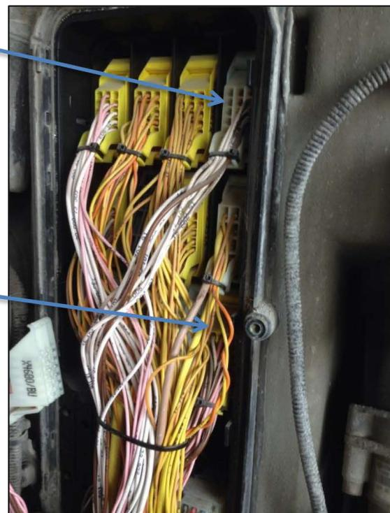
Подключение шины CAN шины эмулятора к разъёму **X1549**:
