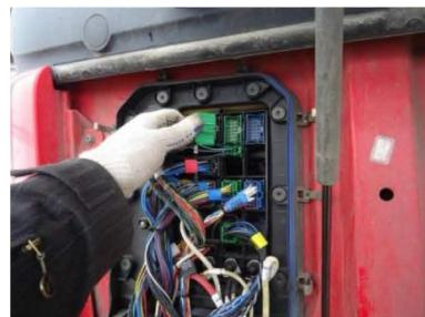
Распиновка разъёма может отличаться в зависимости от года выпуска автомобиля. Подключение производится к витой паре (шина CAN)
