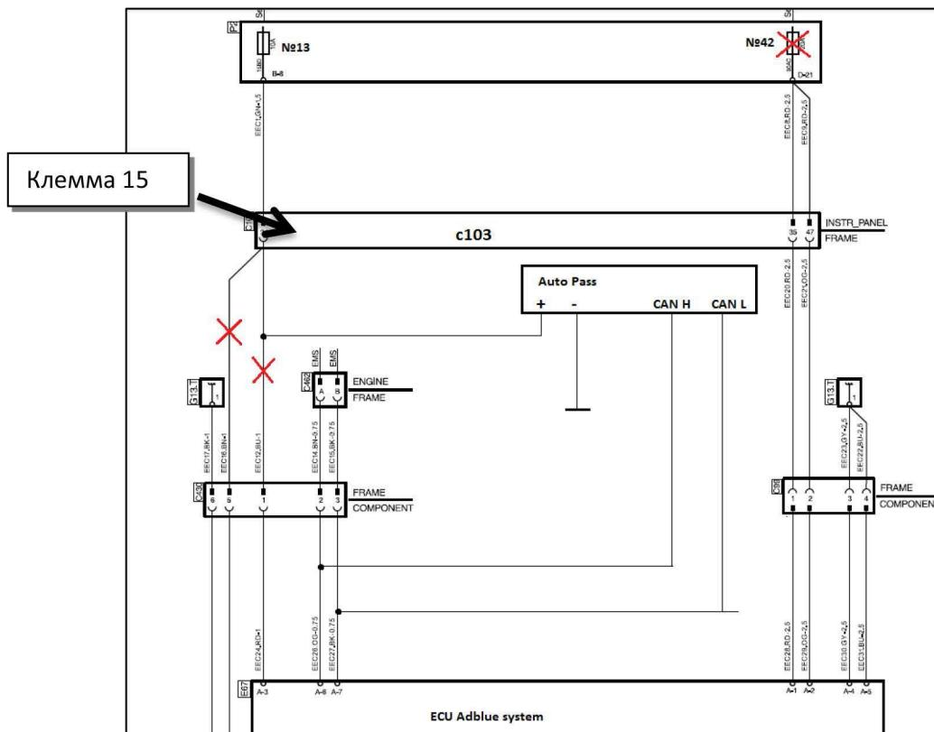
Обесточивание системы SCR и датчика NOx
