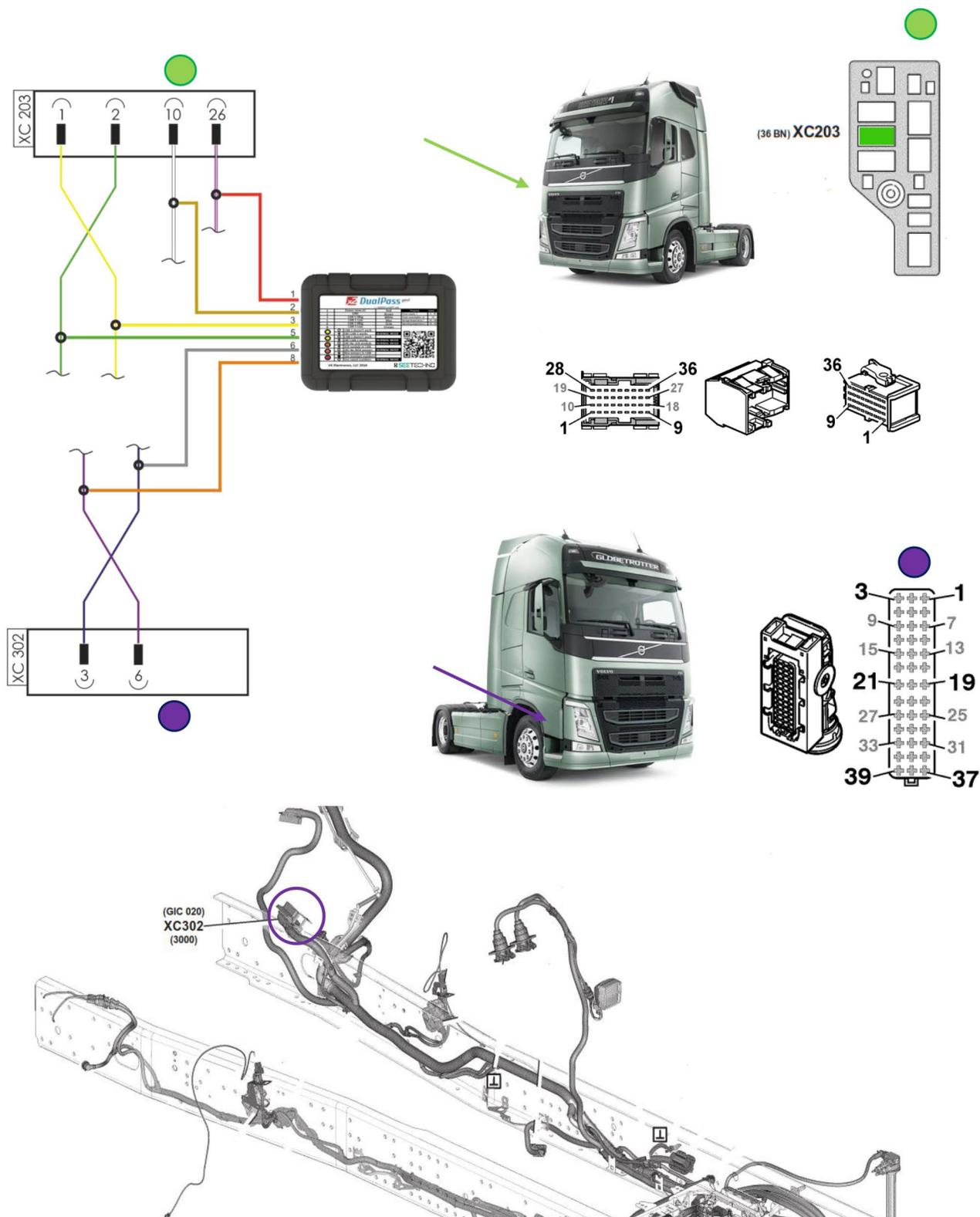
Обесточивание системы SCR – схема 2
