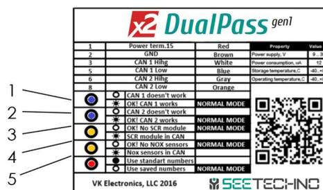
Светодиод **1 (синий)** - режим работы линии **CAN1** – светодиод мигает при нормальной работе линии – светодиод не горит при наличии неисправности в линии.
