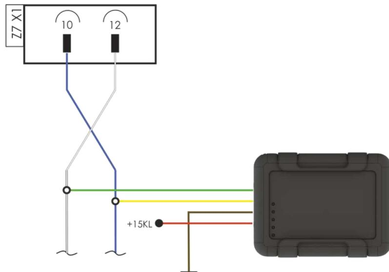
**Внимание!** Расположение разъёма **Z7 X1** и **Z4 X1** может меняться в зависимости от модификации автомобиля, перед установкой необходимо визуально считать номер разъёма написанного на его корпусе.
